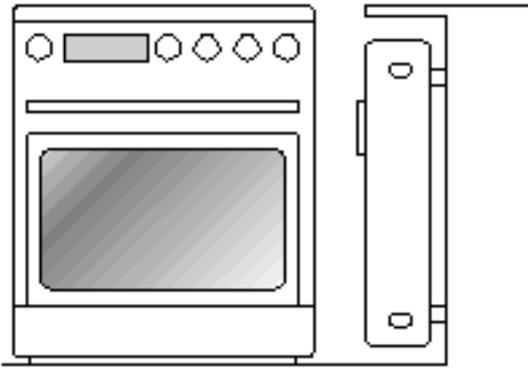
In vielen Wohnungen wird neben der Zentralheizung zusätzlich ein Kachel- oder Kaminofen eingesetzt. Wenn der Heizkörper einen Abstand von ca. 2 Meter zur Wärmequelle hat, kann davon ausgegangen werden, dass eine Auswirkung auf den Heizkostenverteiler kaum, bzw. nicht stattfindet. Sogar eine Raumtemperaturerhöhung von bis zu 5° C wirkt sich auf den Heizkostenverteiler geringer aus, als die übliche Kaltverdunstung.
